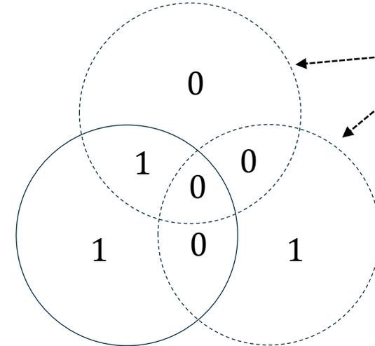
Der Empfänger kann feststellen, dass zwei der Paritätsbits inkorrekt sind...
